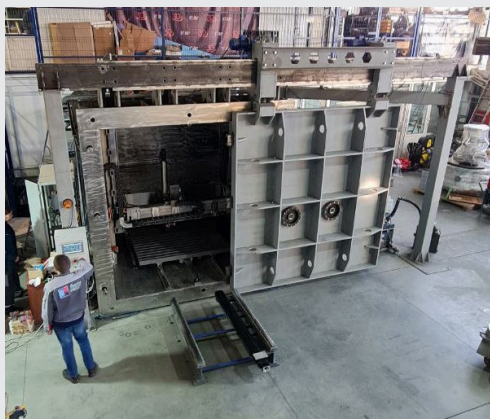
Вакуумный электронно лучевой 3D принтер. Наплавка. Зона построения 1,5x1,5x1,5 м
