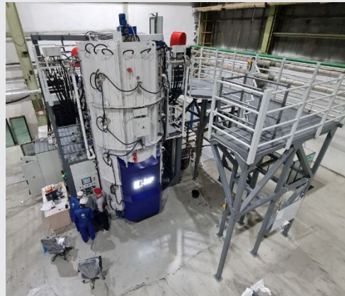
Установка для нанесения покрытий на оболочку твэл. «Толерантное топливо».
