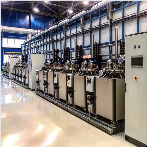
Вакуумная инфузия «Черного крыла» MC-21
