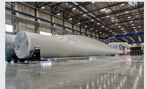
Вакуумная инфузия лопастей ВЭС
