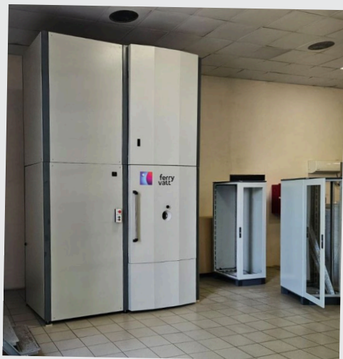
Вакуумный электронно лучевой 3D принтер. Спекание порошков. Зона построения – диаметр 300 мм, высота 400 мм
