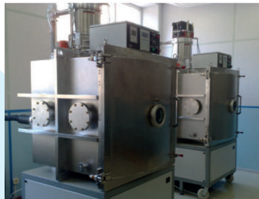
طابعة ثلاثية الأبعاد بالإلكترونيات الحزمية تحت الفراغ. صهر المساحيق. منطقة البناء – قطر 300 ملم، ارتفاع 400 ملم
