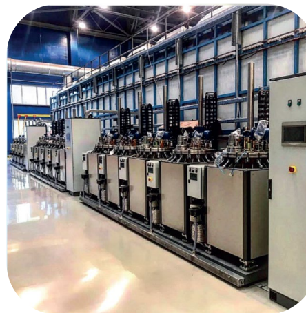
Вакуумная инфузия «Черного крыла» МС-21
