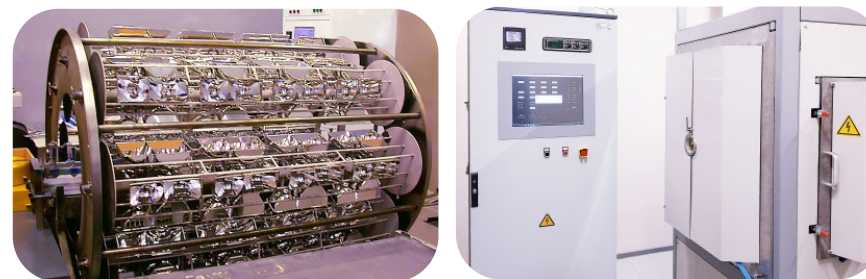
ВАТТ 1600-ТК «Бочка». Нанесение покрытия на отражатели автомобильных фар
